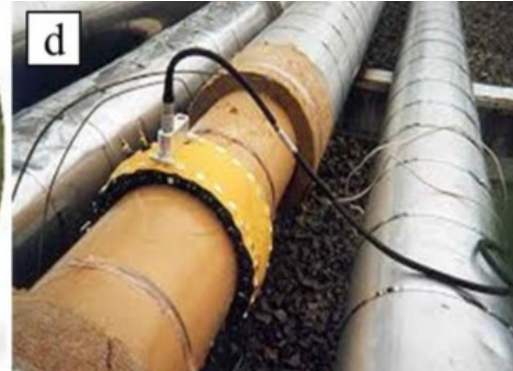
(d) Ultrasonic inspection
